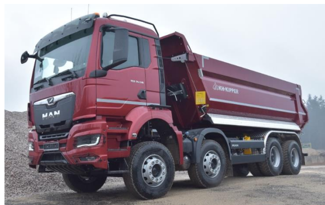
Front / Przedni: 7mm Hardox 400 Side / Boki: 5mm Hardox 400 Rear / Tył: 6mm Hardox 400
